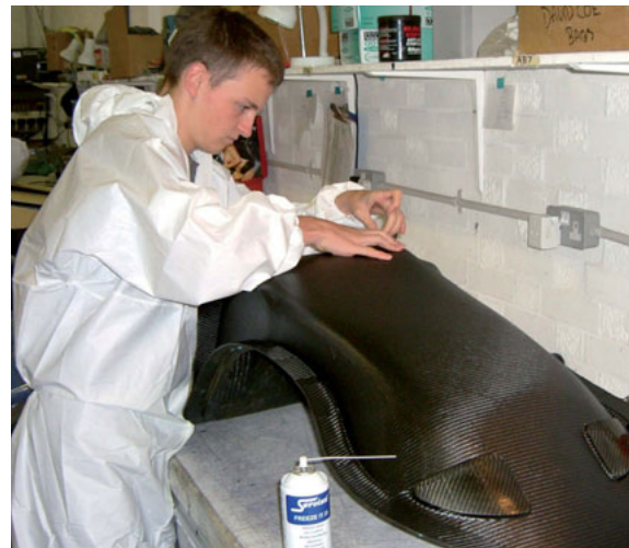
Komposit-Rennsitz in der Fertigung bei Reverie
