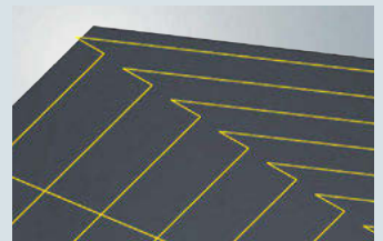
コーナーで特殊な動きをさせた場合の HFC 加工: 削り残り部なし
