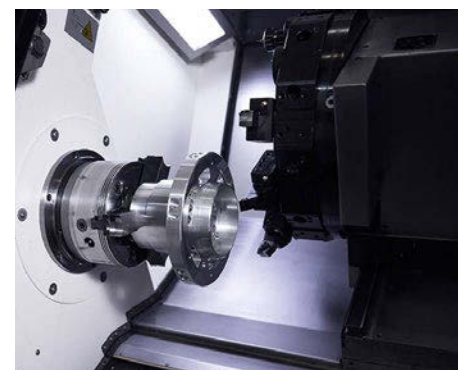
Drehen mit Revolverbestückung auf einer CTX alpha 500 von DMG MORI mit Siemens-Steuerung
