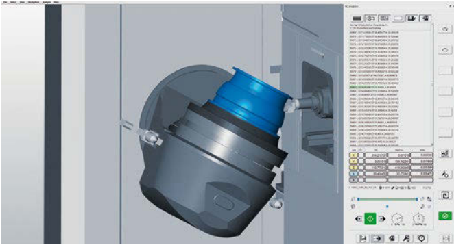
NEU: Im hyperMILL SIMULATION Center und in der virtuellen Maschine werden rotierende Geometrien als solche dargestellt
