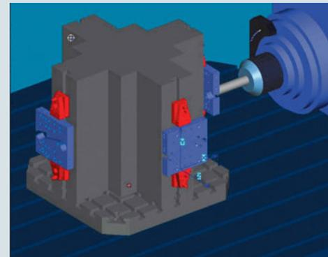
**Serrage multiple:** Cette fonction permet d'usiner des pièces sur plusieurs côtés sans démontage. Des parties du programme peuvent être réexécutées, même lorsque les plans de travail ont été déplacés et pivotés sur la machine.
