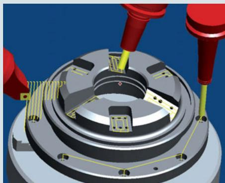
**Au quotidien,** une programmation permettant un changement simple et rapide de stratégie de tournage et de fraisage s'avère particulièrement importante. Grâce à l'implémentation complète du module de fraisage-tournage dans **hyperMILL®**, l'utilisateur sélectionne uniquement la stratégie souhaitée, comme par exemple le dégrossissage tournage. Il n'a pas besoin d'ouvrir un autre programme.
