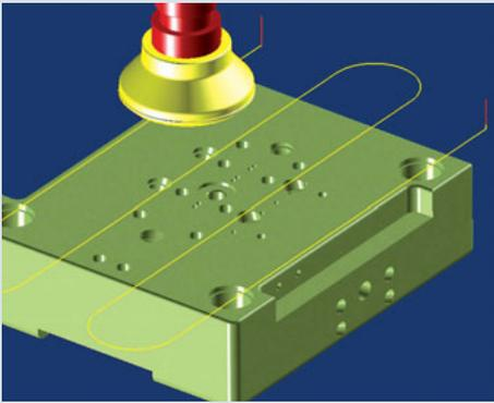
**Surfaçage:** Avec la stratégie « Surfaçage », les zones planes sont usinées rapidement et aisément en mode sens unique ou zigzag. Plusieurs surfaces indépendantes peuvent être usinées au cours d'une même opération.
