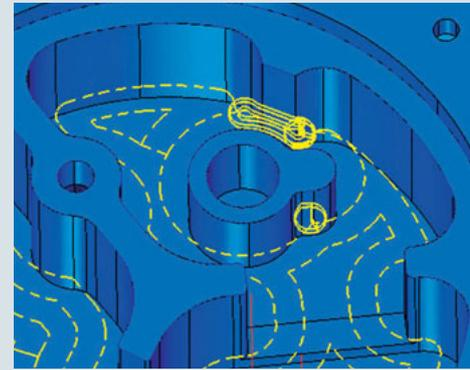
**Usinage de poche:** Toutes les poches peuvent être usinées, même celles comprenant des flots et d'autres poches de hauteur et de profondeur variables. Cette stratégie prend également en charge les cycles de commande pour les poches circulaires et rectangulaires.
