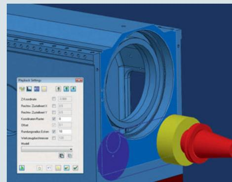
**Fraisage Playback:** Les fraisages simples se programment facilement avec le fraisage « playback ». La génération du parcours d'usinage s'effectue en sélectionnant le diamètre de la fraise, puis en déplaçant la souris sur les zones à usiner.
