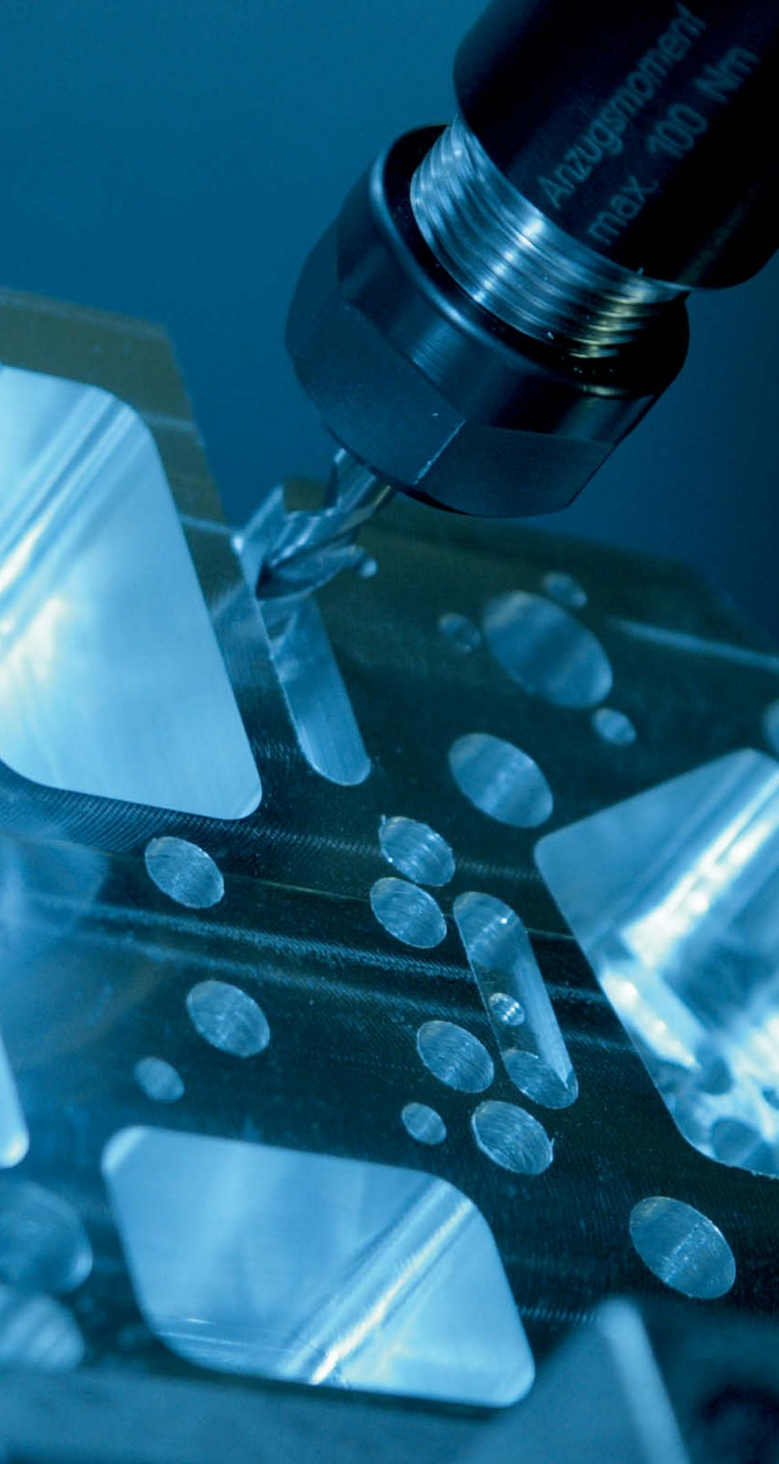
Le surfacage, le fraisage de contours, l'usinage de poches et diverses stratégies de perçage garantissent la programmation simple et rapide pour le fraisage efficace des composants de mécanique générale.
