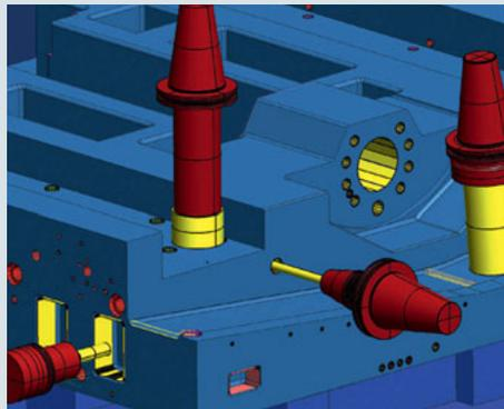
**Perçage multi-axes:** Cette fonction permet de programmer les perçages automatiquement et rapidement avec des positions d'outil différentes dans une opération. Un automatisme calcule la position d'outil et associe les points d'engagement des perçages de manière optimale pour le trajet.
