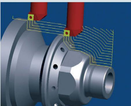
**hyperMILL® millTURN** intègre des stratégies de tournage pour l'ébauche, la finition, la gorge, le filetage et le perçage. L'ébauche peut s'effectuer dans le sens de la longueur, à l'horizontale ou parallèlement aux contours. Plusieurs macros d'engagement et de dégagement permettent de réaliser un usinage optimisé lors de la finition.
