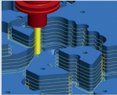
**Contournage:** Les contours complexes sont usinés avec la stratégie « Contournage ». Des fonctions supplémentaires et options, comme la passe axiale et latérale multiple, la passe axiale en spirale ou la définition du point d'approche, permettent d'utiliser cette stratégie dans de nombreux cas.
