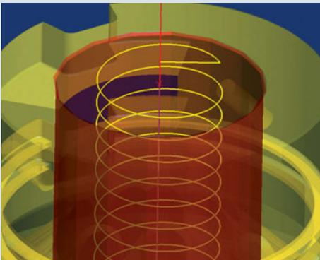
**Perçage hélicoïdal:** Pour le perçage hélicoïdal, la fraise se visse sur une passe hélicoïdale vers le bas. L'angle d'inclinaison de la spirale peut être défini par l'utilisateur dans le cadre technologique applicable. Le filetage à la fraise permet d'usiner un filetage intérieur ou extérieur. L'option de perçage de trous profonds permet de fraiser en profondeur.
