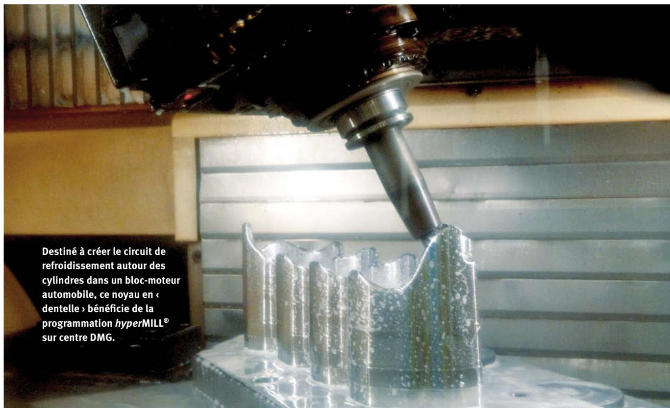
Destiné à créer le circuit de refroidissement autour des cylindres dans un bloc-moteur automobile, ce noyau en « dentelle » bénéficie de la programmation *hyperMILL*® sur centre DMG.
