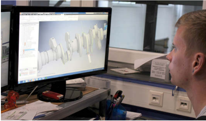
Martin Güntsche programmierte die Kurbelwelle mit dem Fräsdrehmodul hyperMILL ® MILL-TURN Machining
